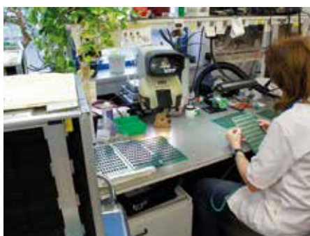
Esame visivo per l'assicurazione qualità (AQ) dei gruppi dei gruppi in dotazione
