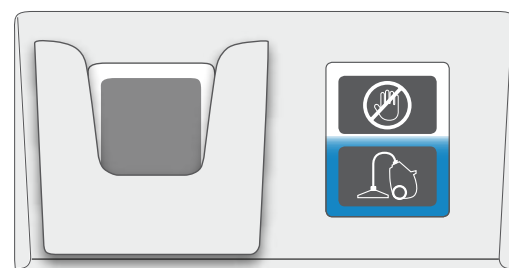
LED BLU INFERIORE Quando si vuole indicare "Pulizia camera". Il campanello è attivo.
